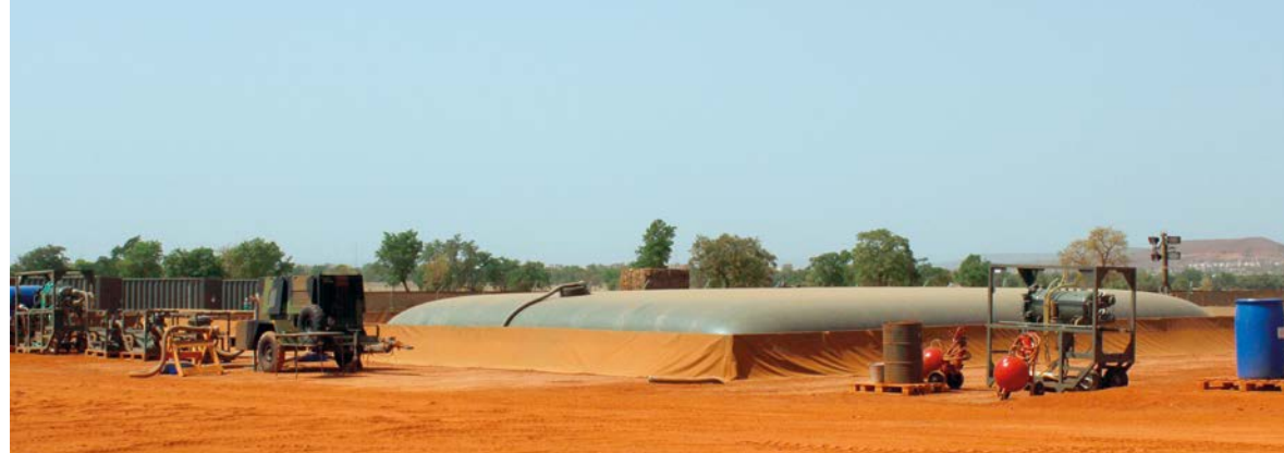
Bac souple du SEA déployé pendant Serval © M. Delaporte, Bamako, Mali, avril 2013
