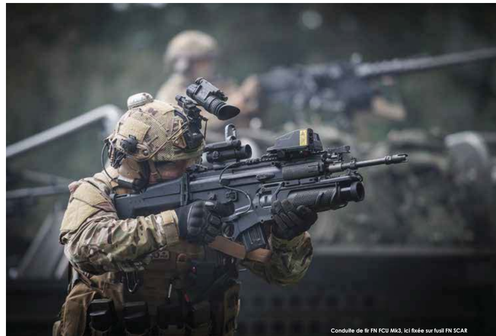
Conduite de tir FN FCU Mk3, ici fixée sur fusil FN SCAR
