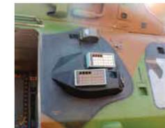
A l'instar de ceux dont sont déjà dotés les Tigre, les boîtiers extérieurs en photo ci-dessus sont des dispositifs de leurrage permettant de protéger le NH90 contre un tir de missile sol-air
